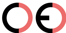
Faux marquage CE (trop éloignée)
